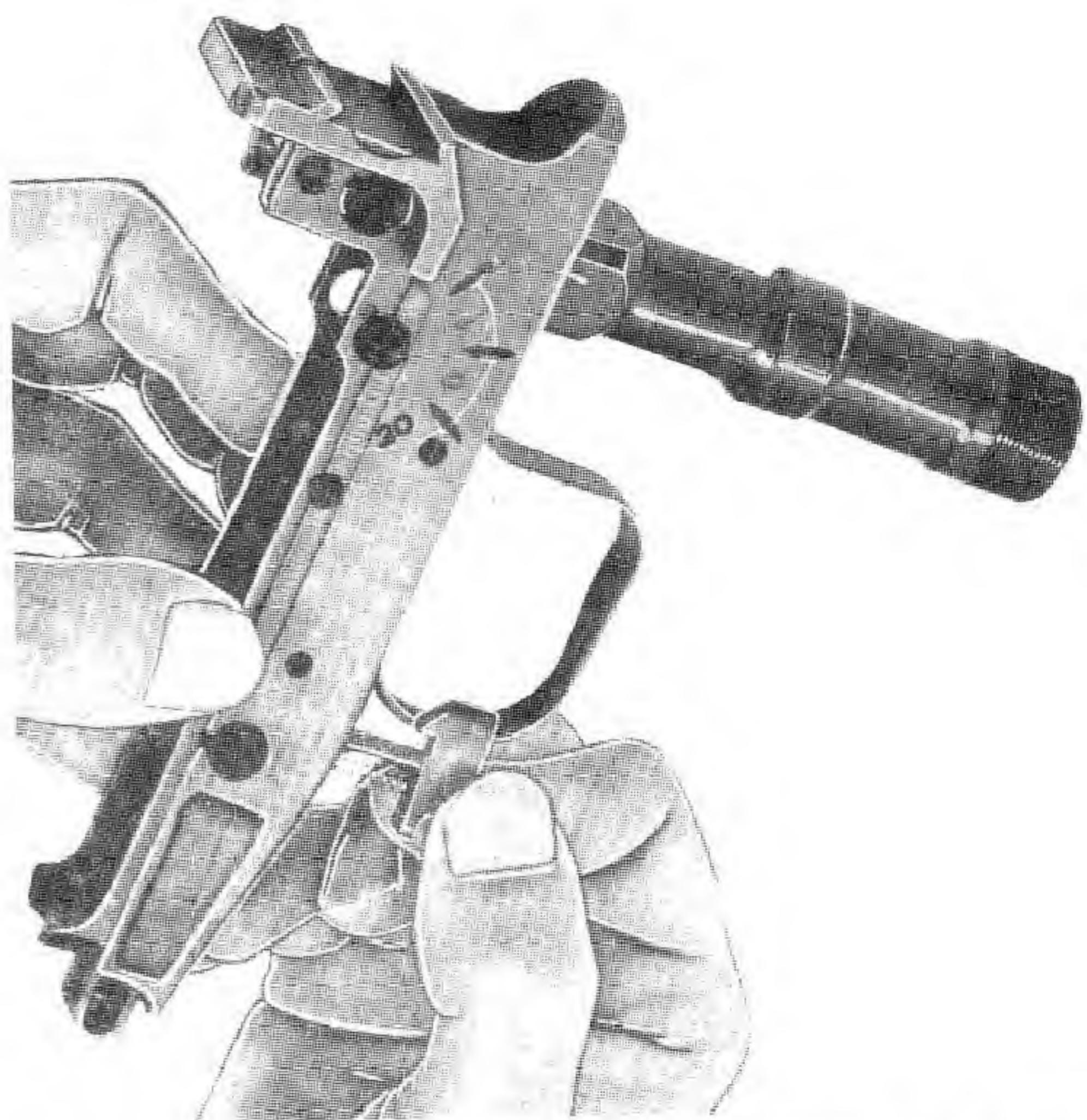
Sl. 85 – Odvajanje zadržača zatvarača sa oprugom od usadnika
